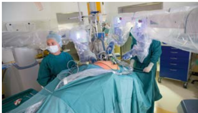
Abbildung 3_ Position der Roboterarme in 3-Arm-Konfiguration
